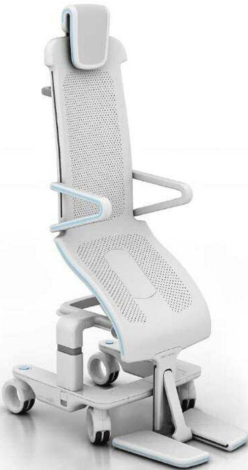
Die Verstellung des Sitzes erfolgt über elektroaktive Polymere (EAP). Eine Polymerfolie wird beidseitig elektrisch leitfähig beschichtet. Bei einer elektrischen Spannung wirken elektrostatische Anziehungskräfte auf das Material - die elastische Folie dehnt sich aus. Um die Wölbung der Fläche zu gewährleisten, wird diese an einzelnen Punkten mit unterschiedlicher Spannung versehen.
