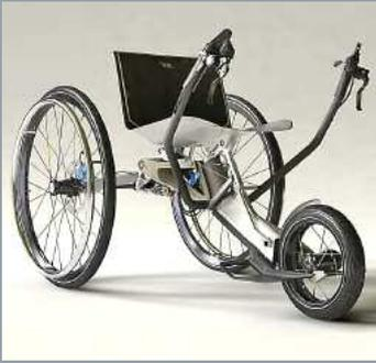
Das Ergebnis der Entwicklung ist ein Rollstuhl, der im Außenmodus mit Hilfe der Neigungslenkung gesteuert und durch einen Hebelantrieb mit Getriebeübersetzung angetrieben wird. Hierbei teilt sich der Rollstuhl in zwei Baugruppen auf. Das Vorderrad bildet gemeinsam mit dem Sitz und einer starren Achse die erste Baugruppe, die Hinterräder mit der Hebel-, Antriebseinheit und Längsverstellung die Zweite. Verbunden sind beide Systeme über ein achsiales Gelenk.
